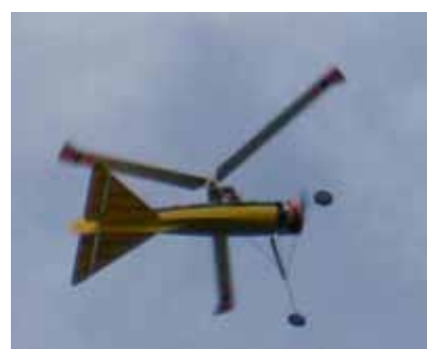
L'autogiro n°6 di Bugada può volare con l'ala o senza. Questo hovering contro vento, motore elettrico al minimo, mostra chiaramente l'elevatore per il comando cabra / picchia che viene invece effettuato col controllo diretto del rotore sugli altri modelli.
