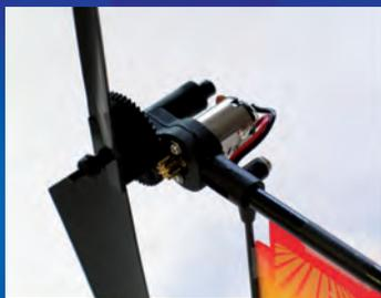
Il Safari H41 utilizza il nuovo motore N30 per il rotore di coda.
