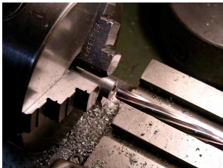
*Particolare attenzione va posta alla quota di spessore dell'alloggiamento cuscinetti che, se diversa da 3 mm, va spessorata all'interno o all'esterno sulla spalla del cuscinetto in modo da contenere in + o - un centesimo la quota nominale*
