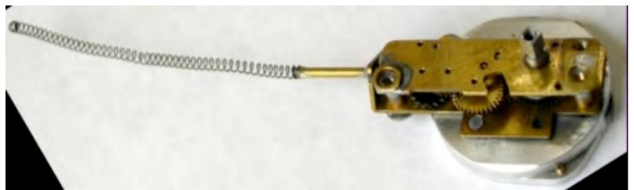
ingranaggi (primo pignone dopo la molla) che, se sottoposti ad un eccessivo sforzo durante la fine carica, possono spezzare la base di un dente del pignone con probabile blocco dell'autoscatto.
