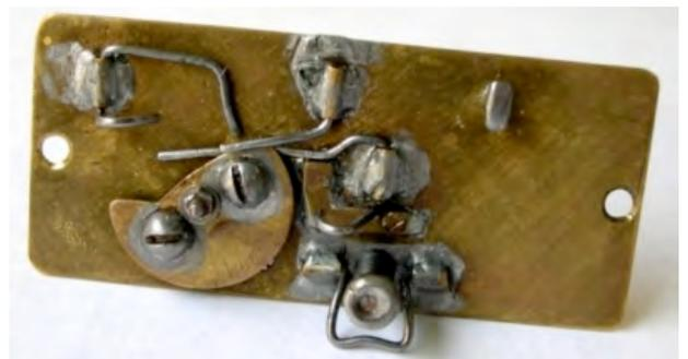
Il sistema adottato per lo spegnimento del motore variava alquanto: chi preferiva azionare una valvolina a cassetto per interrompere la miscela o ne faceva aspirare aria e chi strozzava il tubetto della miscela per bloccare il flusso del combustibile.
